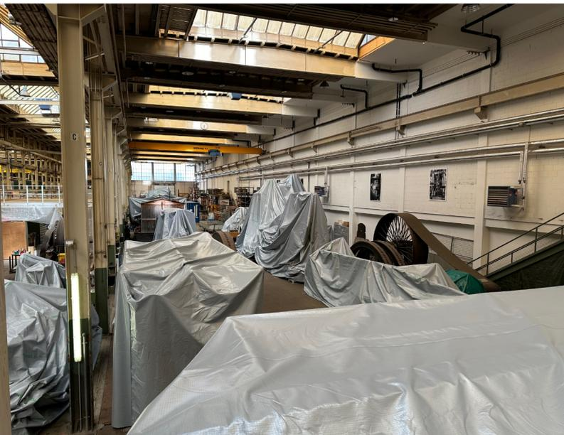
Die Dampfmaschinen sind mittlerweile «ausgepackt». Wir mussten aber feststellen, dass sich der feine Betonstaub auch unter den Blachen überall verteilt hatte, was für uns viel Putzaufwand bedeuten wird. Andererseits durften wir erfreulicherweise auch konstatieren, dass sich kaum Rost angesetzt hatte.
