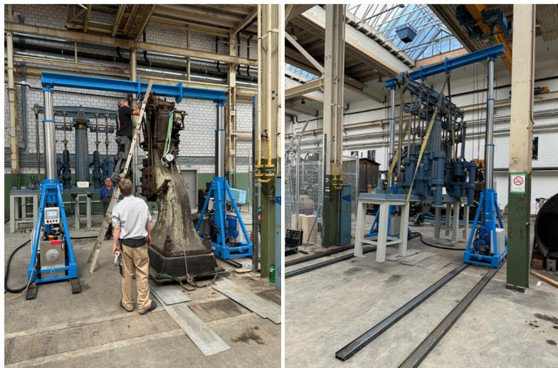
So mussten wir die Balancier-Dampfmaschine (ca. 6 Tonnen schwer) mittels einer speziellen Hebevorrichtung verschieben und genau platzieren, was bei den Ausmassen der Maschine und deren Gewicht ziemlich herausfordernd war.
